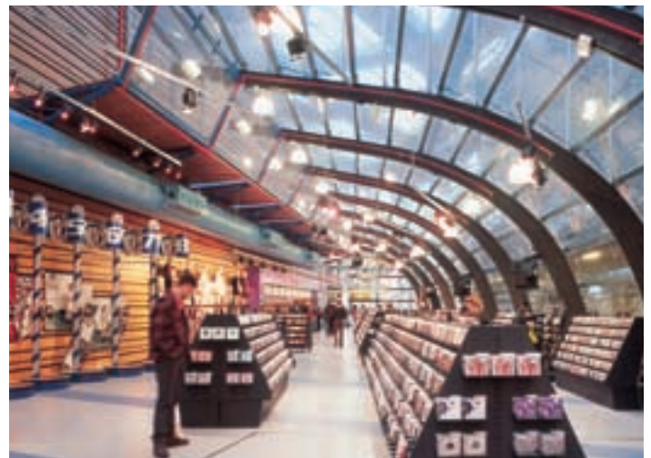
Bild 14: Gleichmäßiger Tageslichteinfall durch das Sheddach – ideale Voraussetzung für eine Konstantlichtregelung
