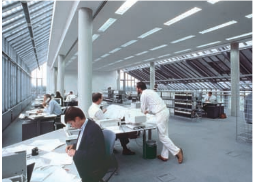
Bild 12: Eine Konstantlichtregelung spart im Vergleich zu unregelmäßigem Betrieb mit elektronischen Vorschaltgeräten (EVG) mindestens die Hälfte der Energie.
